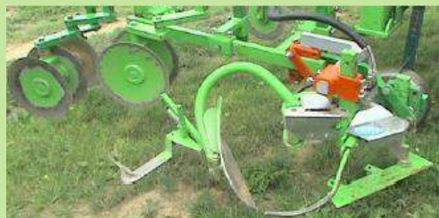
lame Binalex + Buttalex + deux disques émietteurs + trois disques émietteurs ©Invenio
